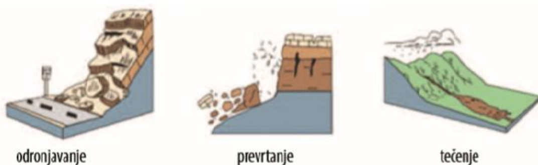
Slika 16: Prikaz osnovnih tipova klizanja prema mehanizmu kretanja
